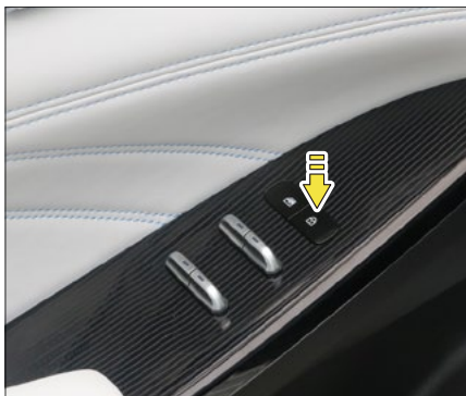
Interruttore centrale interno di blocco delle portiere
