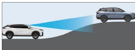
5. Quando il veicolo sta percorrendo una salita, il sistema ACC potrebbe non essere in grado di rilevare dei veicoli nella medesima corsia.
